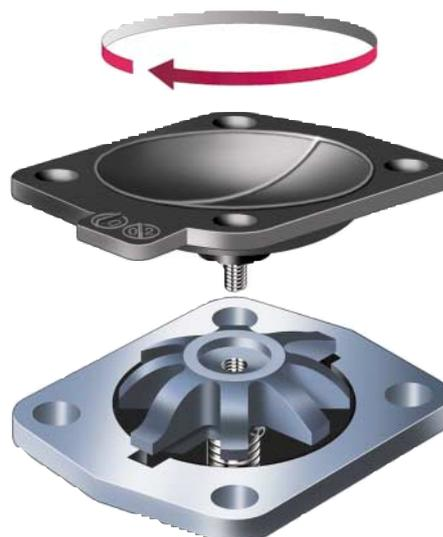
Gummimembrane mit Schraubbefestigung
