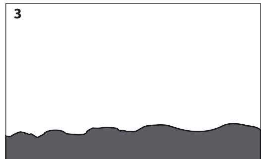
Rysunek przedstawia progresywne usuwanie metalu w wyniku polerowania elektrolitycznego prowadzącego do utworzenia równomiernego zarysu powierzchni.
