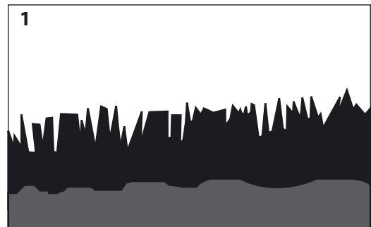
Rysunek przedstawia zarys powierzchni metalowej powstałej w wyniku obróbki mechanicznej.
